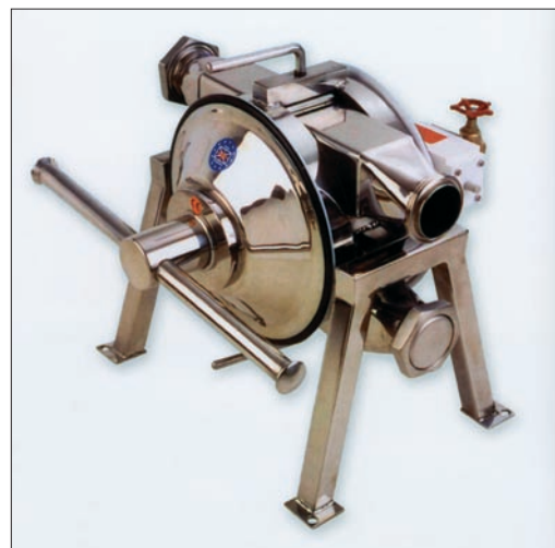
Obr. 3. Čerpadlu z korozivzdorné oceli s membránami o průměru 14" nevedí tuhé částice do průměru až 25 mm (např. ovoce, kousky zeleniny)
